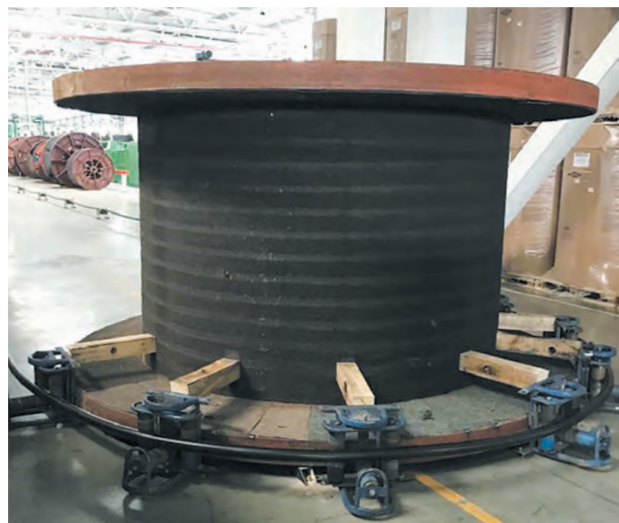
Рис. 5. Проведение эксперимента PRE-Twist кабеля
