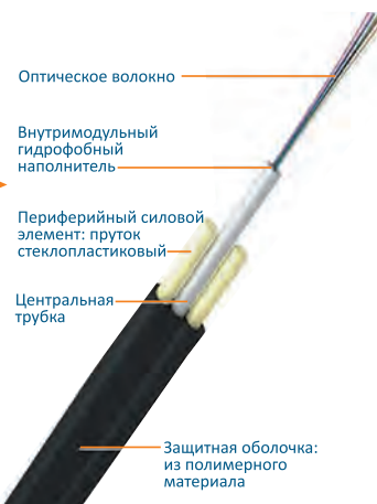
Рис. 7. Кабель с включением в медный экран плоского оптического кабеля. Конструкция плоского оптического кабеля
