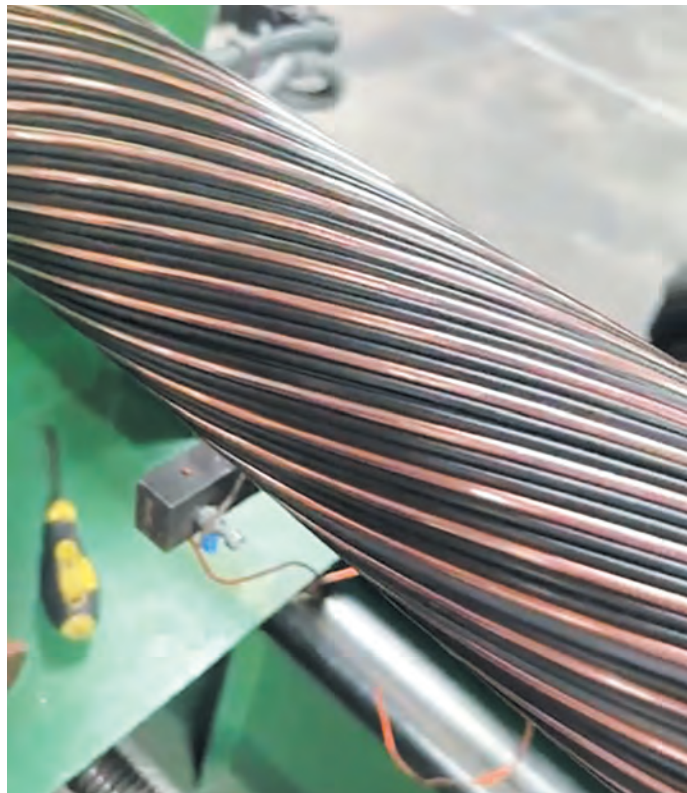
Рис. 11. Медный экран с полиэтиленовыми жгутами между проволоками
