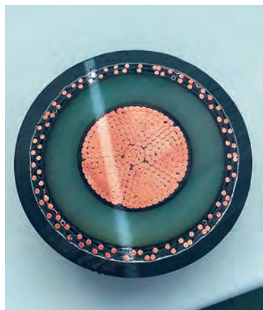
Рис. 9. Кабель с двойным медным экраном. Повреждение проволок медного экрана и оптического модуля
