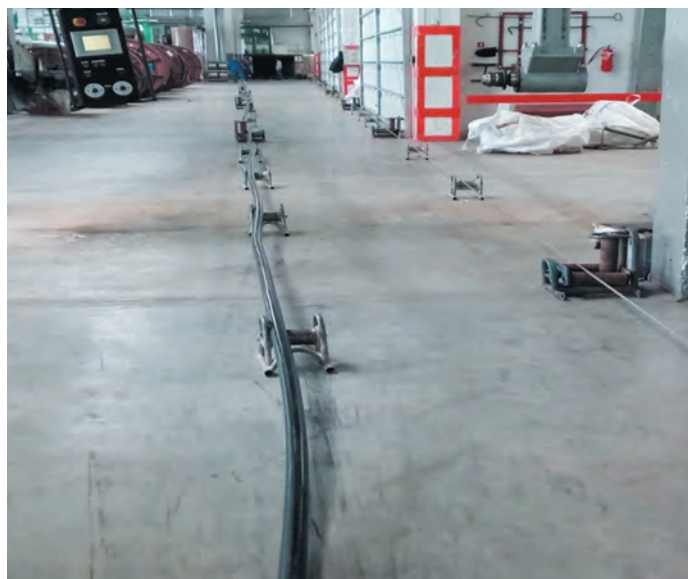
Рис. 5. Проведение эксперимента PRE-Twist кабеля
