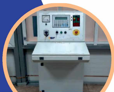
Испытательная станция SIF до 15 кВ
