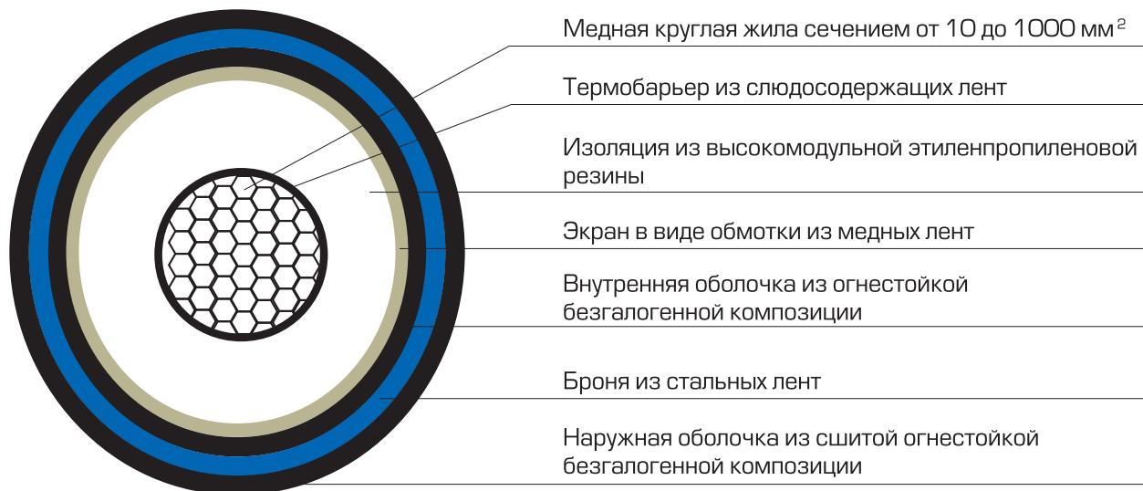
Кабель силовой марки РЭЭБПснг(А)-FRHF, с изоляцией из высокомодульной этиленпропиленовой резины, экраном в виде обмотки из медных лент, бронированный стальными лентами, внутренней оболочкой из огнестойкой полимерной композиции, не содержащей галогенов, с наружной оболочкой из огнестойкой свитой полимерной композиции, не содержащей галогенов, на напряжение 0,66-3,0 кВ. Кабель соответствует требованиям стандартов на кабели низ-
